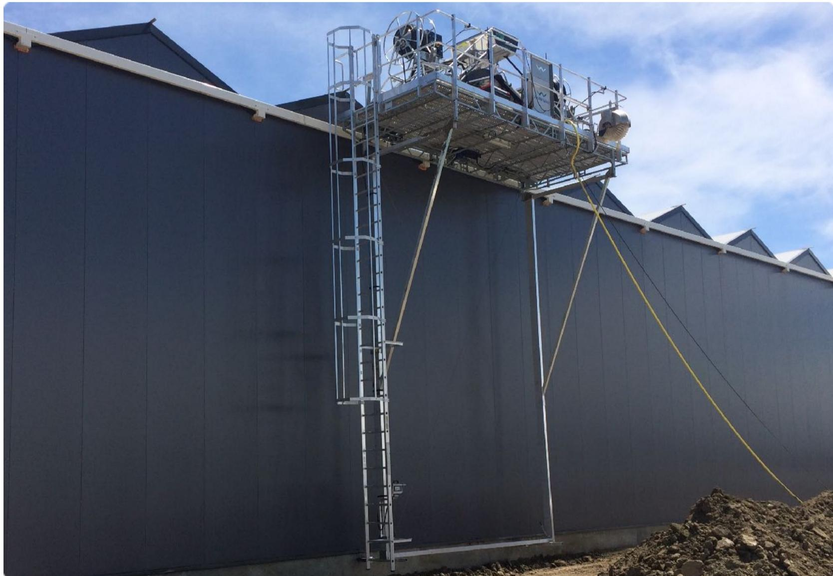
棚顶清洗机和工作平台均通过遥控器手工操作，因此全程需人工参与。先将工作平台置于温室天沟前部，然后控制坡道，直至其进入天沟内。当棚顶清洗机再次返回平台之后，可以很方便地使用遥控器控制平台进行侧向移动，在到达下一个屋脊时，平台会自动停止。每个工作平台都包含：
