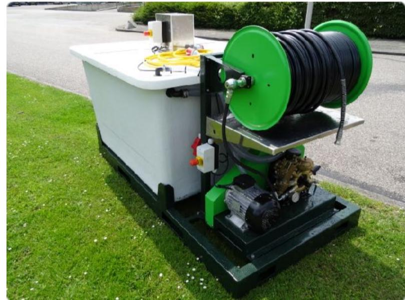
**喷涂泵拖车，一个1600升搅拌桶，电压：400/480伏，电流频率：50/60赫兹
