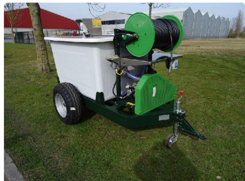
**喷涂泵拖车，两个1000升搅拌桶，电压：400/480伏，电流频率：
